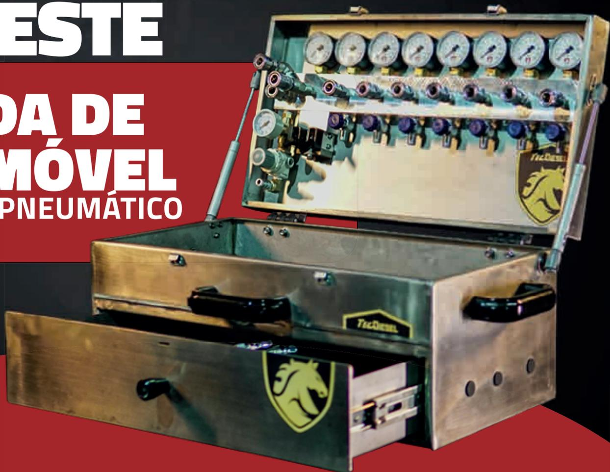
Estação móvel para testes dos sistemas pneumáticos, que permite um rápido e preciso diagnóstico do funcionamento dos sistemas que utilizam ar no caminhão e/ou carreta. Pode utilizar o ar da rede ou do próprio caminhão para realizar os testes. Totalmente portátil e compacta, feita em aço inox e possui uma gaveta para apetrechos.
